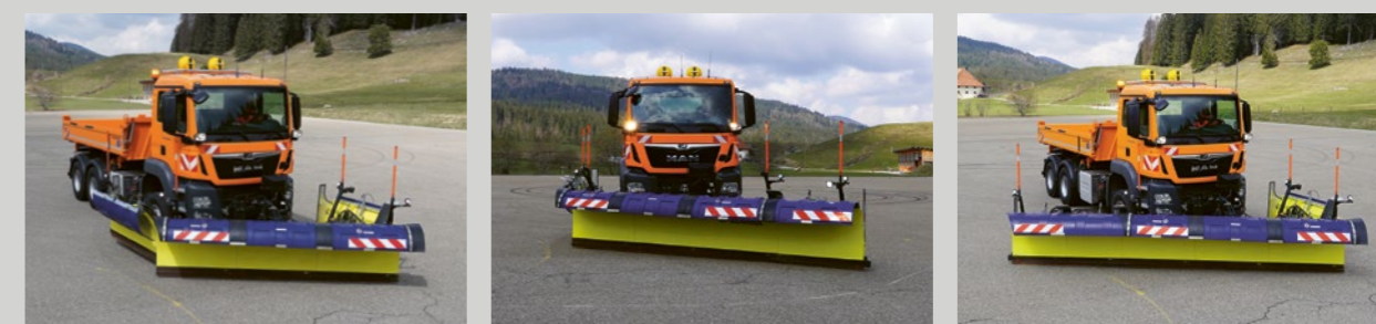
Der Schmidt Tarron HP-2W Hochleistungspflug räumt auf einer Breite von bis zu 6,2 Metern.
