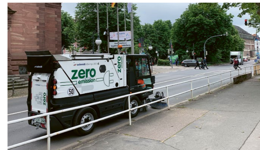
Die Schmidt eSwingo 200+ reduziert die CO 2 -Emissionen pro Schicht um bis zu 158 kg.
