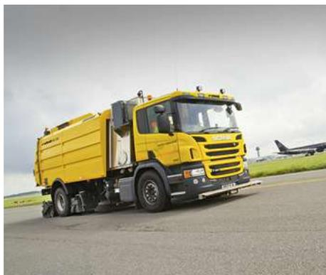
L'ASC 990 est une balayeuse haute performance d'aéroport équipée en sus d'un kit pour le nettoyage des postes de stationnement avion. Cette version est particulièrement adaptée pour le décapage en profondeur des surfaces souillées.
