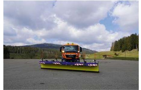
Toute dépliée la lame atteint une largeur de travail de 6,2 m, panneau gauche fermé 5,1 m, panneau droit fermé 4,5 m. Les deux panneaux d'extrémité rétractés, la Tarron HP-2W atteint une largeur de travail de 3,4 m. Aussi bien pour la position de transport que de travail, les panneaux escamotables sont commandés hydrauliquement et la largeur de passage hors tout rapidement minimisée. Au travail les panneaux repliés sont aussi automatiquement relevés.
