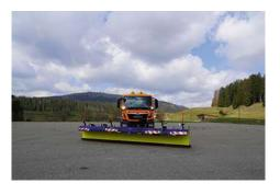
Toute dépliée la lame atteint une largeur de travail de 6,2 m, panneau gauche fermé 5,1 m, panneau droit fermé 4,5 m. Les deux panneaux d'extrémité rétractés, la Tarron HP-2W atteint une largeur de travail de 3,4 m. Aussi bien pour la position de transport que de travail, les panneaux escamotables sont commandés hydrauliquement et la largeur de passage hors tout rapidement minimisée. Au travail les panneaux repliés sont aussi automatiquement relevés.
