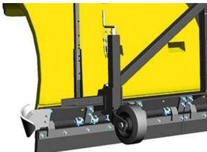
2. Roues pivotantes SNK avec empilage de rondelles de réglage en hauteur.
