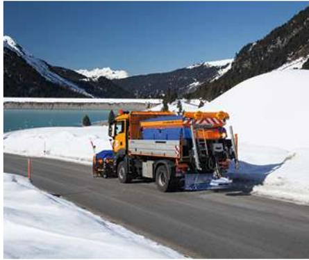
Der Stratos 50 ist ein Aufbau-Streugerät mit einer Behältergrösse von 5 m<sup>3</sup>.
