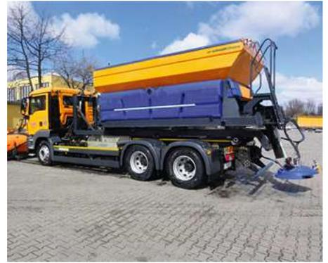
Der Stratos 100 ist ein Aufbau-Streugerät mit einer Behältergrösse von 10 m<sup>3</sup>.
