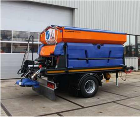
Der Stratos A50K ist ein Anhänger-Streugerät mit einer Behältergrösse von 5 m<sup>3</sup>.
