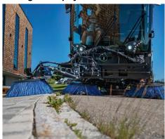
Avec le troisième balai en option, la largeur de travail peut être augmentée à 3 550 mm. Cela permet un rendement surfacique plus important et un balayage sur deux niveaux.
