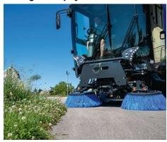
Un système de balayage flexible garantit un résultat propre dans toutes les situations. Le système de balais tirés à assiette, monté devant l'essieu avant, offre une largeur de balayage de 2 200 mm.
