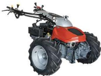
Le Combicut CC 150 est entraîné par un moteur essence à deux cylindres de **18 chevaux**. Sa conception compacte permet de réaliser des travaux dans des endroits exigus et d'installer de grands équipements attelés sans pour autant perdre de la puissance.
