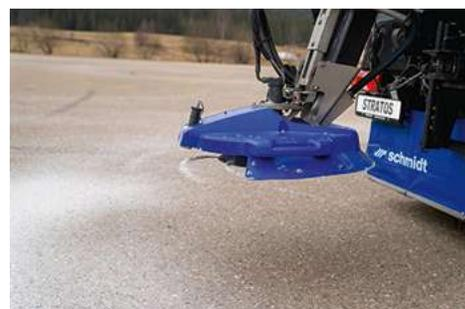
Le mécanisme de pivotement de l'axe de l'assiette permet de régler la symétrie ou l'asymétrie d'épandage manuellement ou électroniquement via le pupitre de commande. Grâce à cette technique, le même spectre de distribution est conservé et est atteint avec exactitude quelle que soit la largeur réglée de 2 à 10 m ou 3 à 12 m.
