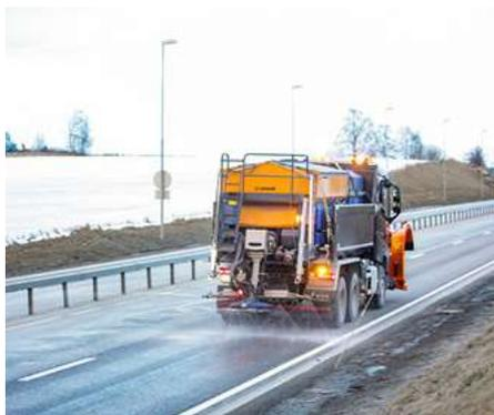
La Stratos WPS 50K a une capacité de 5 m<sup>3</sup> et est équipée d'un système de distribution WPS.
