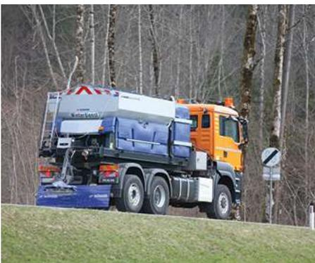
La Stratos CS RSP 50 K Flex Low a une capacité de 5 m<sup>3</sup> avec deux réservoirs dépliables à membrane K-Flex Low pour la saumure et un système de distribution RSP.
