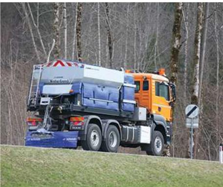
La Stratos CS RSP 50 K Flex Low a une capacité de 5 m<sup>3</sup> avec deux réservoirs déployables à membrane K-Flex Low pour la saumure et un système de distribution RSP.
