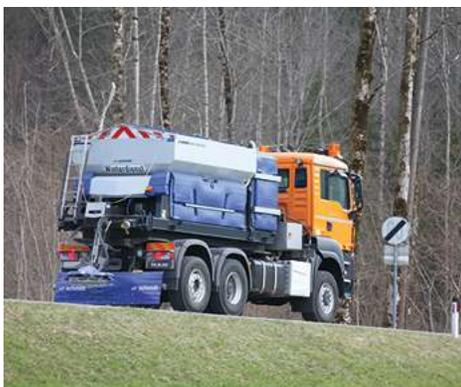
El Stratos RSP 50K Flex High tiene una tolva de 5,0 m<sup>3</sup> de capacidad con dos bolsas Flex integradas y va equipado con el sistema de distribución RSP.
