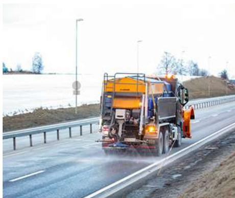
El Stratos WSP 50K tiene una tolva de 5,0 m<sup>3</sup> de capacidad y lleva instalado el sistema de distribución WSP.
