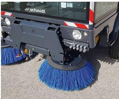
Ce système de balayage maniable garantit un résultat propre dans chaque situation. Les balais tirés installés au devant de l'essieu avant offrent une largeur de balayage de 2 200 mm.
