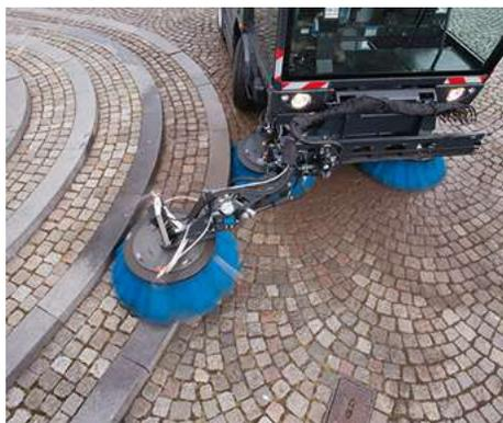
L'option troisième balai porte la largeur jusqu'à 3 550 mm augmentant la surface balayée. Le balayage peut également être réalisé sur deux niveaux.
