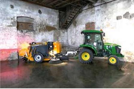
Die Kehrereinheit der MSH besteht aus zwei gestossenen Tellerbesen mit Antrieb über die Zapfwelle des Zugfahrzeugs (540 1/min). Über das Bedienpult lässt sich das hydraulische Heben und Senken der Tellerbesen steuern. Die MSH hat zusätzlich eine gezogene, anfahrteschutzte Besenwalze im Heck. Ein Hydraulikmotor ermöglicht einen verschleissfreien Direktantrieb. Eine nachstellbare Besenwalzenabdeckung sichert ein optimales Kehrergebnis.
