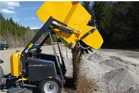
Die MSH Anhängkehrmaschinen haben einen Stahlbehälter mit 0,7 m<sup>3</sup> bzw. 1,5 m<sup>3</sup> Fassungsvermögen. Die Auskipphöhe beträgt 1.500 mm bzw. 1.800 mm. Der Behälter wird hydraulisch nach hinten gekippt.
