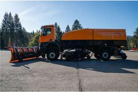
La CJS peut être montée en série sur le véhicule porteur Mercedes-Benz Arcos 2036, de type châssis. Ce véhicule porteur présente un rayon de braquage de 18 mètres et offre l'option d'une direction supplémentaire de l'essieu arrière pour une plus grande agilité. L'exécution de base et la norme d'émission gaz de la motorisation (jusqu'à Euro6) du véhicule porteur sont à définir suivant le client / réglementation pays.
