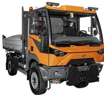
La **charge utile maximale** de **4 800 kg** et le délestage hydraulique à l'avant du véhicule font du MT 770 un partenaire fiable pour les **travaux difficiles**. Le **poids total** atteint **7 500 kg**.
