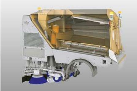
Das Schmutzbehältervolumen von 7,0 m<sup>3</sup> ermöglicht die Aufnahme grosser Schmutzmengen. Die Bodenwanne aus rostfreiem Edelstahl sowie gummierte Prallbleche im Behälter garantieren eine lange Lebensdauer und sind nahezu verschleissfrei.
