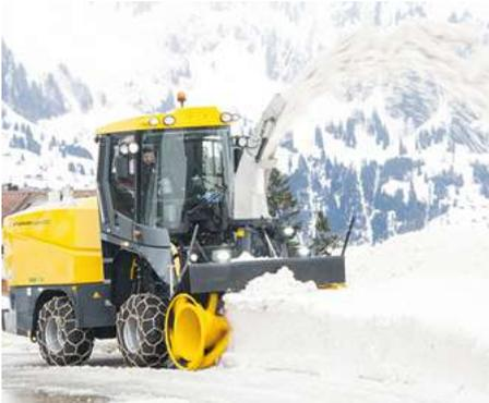
La Supra 4002 est une turbo-fraise automotrice avec une largeur d'avant train de 2400, 2600 ou 2800 mm.
