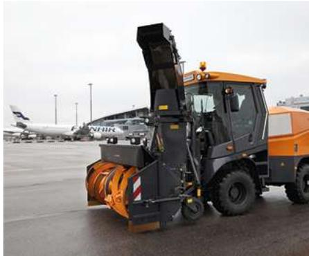
La Supra 5002 est une turbo-fraise automotrice avec un avant train de largeur de 2400, 2600 ou 2800 mm.
