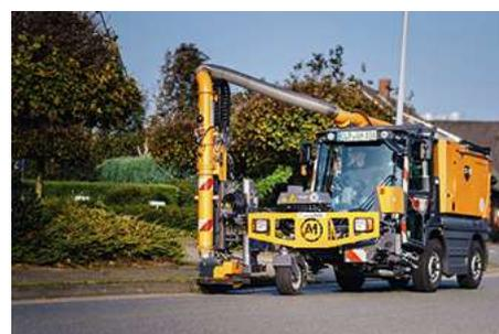
La balayeuse aspiratrice compacte **Cleango CS500 SKR** a un volume d'eau propre d'environ 700 litres qui permet ainsi de longues heures de travail. En option, le volume d'eau peut être augmenté via des réservoirs supplémentaires.
