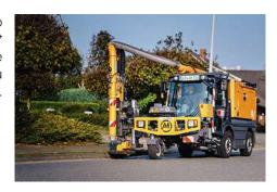
La balayeuse aspiratrice compacte **Cleango CS500 SKR** a un volume d'eau propre d'environ 700 litres qui permet ainsi de longues heures de travail. En option, le volume d'eau peut être augmenté via des réservoirs supplémentaires.
