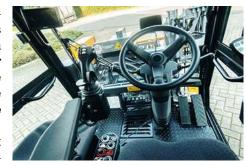
licatement équilibré permet un travail précis et facile. À l'intérieur de la cabine du conducteur, une colonne de direction réglable en hauteur et en inclinaison assure une position confortable, même pour les conducteurs de grande taille. Des commandes de fonctionnement ergonomiques et une cabine entièrement climatisée garantissent un environnement de travail sans stress. Le conducteur contrôle les opérations manuellement à l'aide d'un seul joystick.
